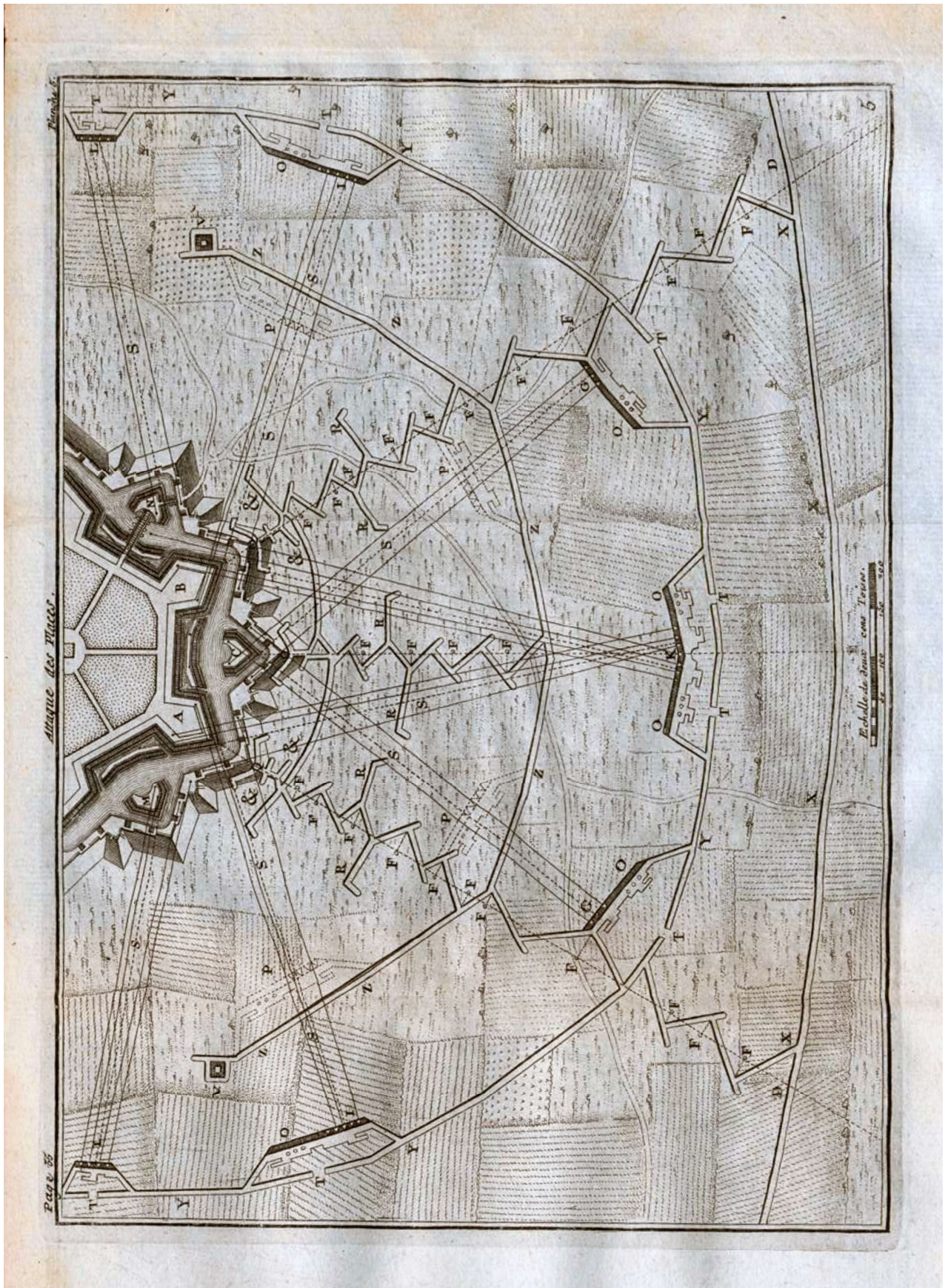
Abbildung 1: Förmlicher Angriff in der Ebene auf eine bastionierte Festung nach der I. Vauban'schen Manier bis zum gedeckten Wege (äußeren Grabenrand), bestehend aus den drei Parallelen, den Approchen, den Flügelredouten und den Batterien vor der ersten Parallele in etwa 800-1000 Schritt vor der Hauptumwallung.
