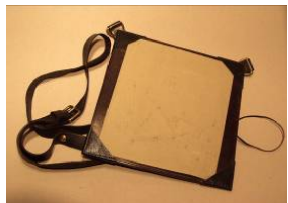
Abbildung 7: Planchet (auch: Campagneplanchette) zum Krokieren nach Decker, welches über die Schulter gehängt wird. Darauf ist der Entwurf eines Dreiecksnetzes für die Triangulation zu sehen (Reproduktion des Autors).
