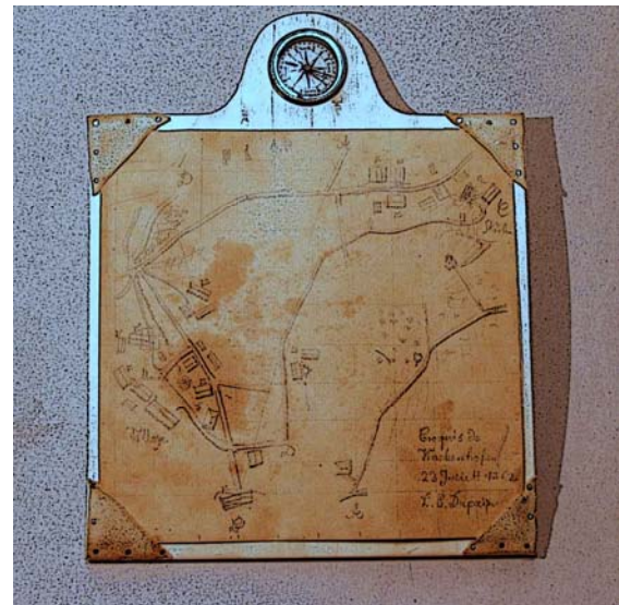
Abbildung 6: Krokierbrett mit Kompass (Rekonstruktion)
