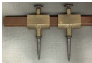
Abb. 3: Stangenzirkel wurden zum Kopieren von Plänen oder Übertragen genauer Längen für großformatige Pläne oder Karten benutzt.
