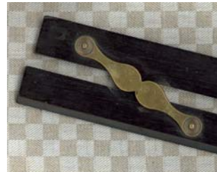
Abb. 5: Parallellineal (Ebenholz, Messing, 19. Jahrhundert)
