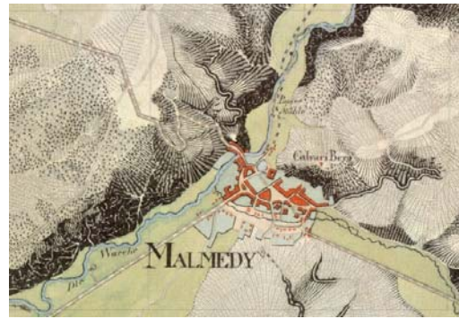
Abb. 14: Reinzeichnung zusammengeführter Messtischaufnahmen in ein Blatt mit Gradabteilung nach den Musterblättern von 1818. (1:20.000)
