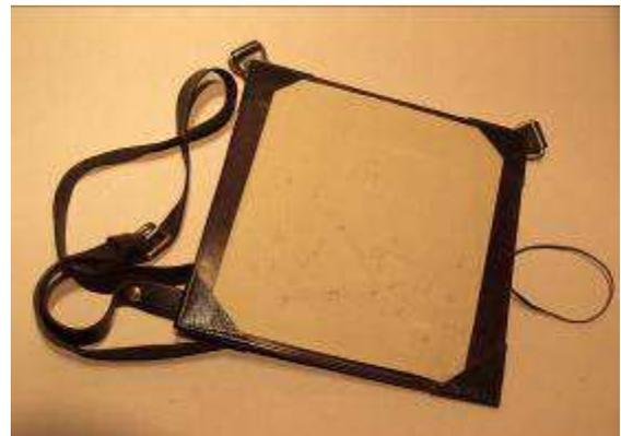
Abbildung 10: Planchet (auch: Campagneplanchette) zum Krokieren nach Decker, welches über die Schulter gehängt wird. Darauf ist der Entwurf eines Dreiecksnetzes für die Triangulation zu sehen (Reproduktion des Autors).
