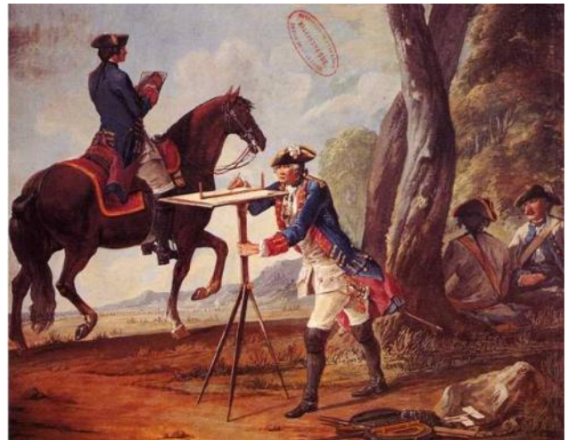
Abbildung 3: Französische Ingenieure beim Krokieren zu Pferde und bei der Meßtischaufnahme. Im rechten Vordergrund ein Graphometer im Futteral, eine Meßkette, Peiltafeln und Zählstäbe. Die Gehilfen sitzen abseits, während man im Hintergrund ein Feldlager erkennt. (Frontispiz des Werks Plan de la bataille de Laffeldt en 23 plans particuliers, 1747 , von J. Berthier, ca. 1759-1763)
