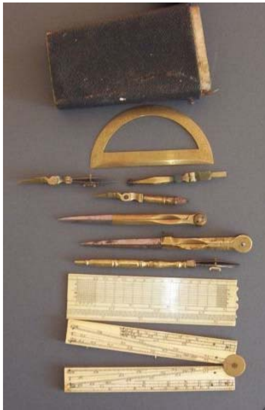
Abbildung 22: Inhalt eines englischen Taschenbestecks: Transporteur, Ziehfeder für Stückzirkel, Kopierrad, Bleistifteinsatz für Stückzirkel, Stechzirkel, Stückzirkel, Ziehfeder, Transversalmaßstab, Proportionalzirkel für einfache Überschlagsrechnungen (England, Dollond aus der 2. Hälfte 18. Jahrhunderts)
