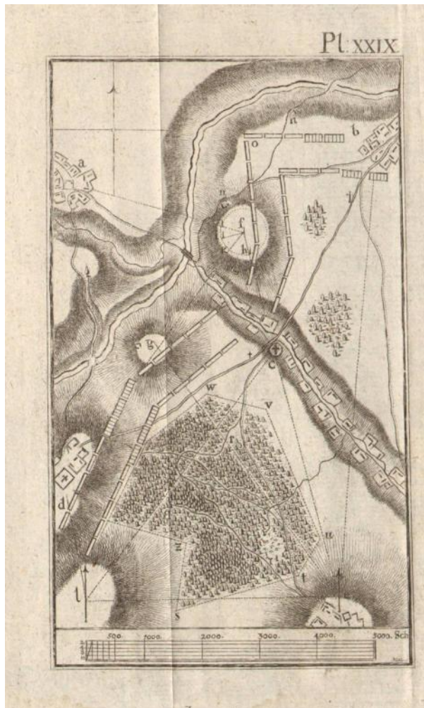
Abbildung 12: Musterlösung für die Erkundung des Terrains vor den eigenen Linien, die durch einen Fluß gedeckt sind. Die erste Aufstellung ist durch Höhen gedeckt. Die Ausrichtung erfolgt nach magnetisch Nord (siehe Pfeile). Berge und Kirchtürme dienen als trigonometrische Punkte im Netz. Entfernungen laut Transversalmaßstab in Schritt. (Tielke, Plan XXIV).
