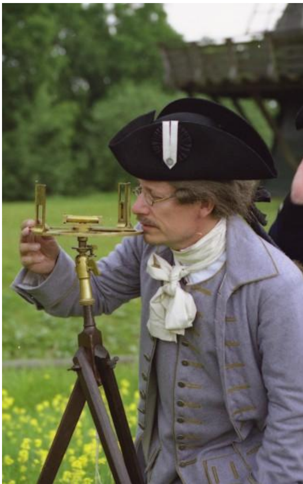
Abbildung 18: Winkelmessung mit dem Graphometer (Rekonstruktion, © Autor)
