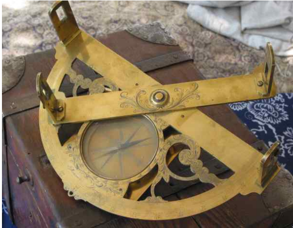
Abbildung 17: Französischer Graphometer (Halbkreiswinkelmesser) aus der Werkstatt Menant, ca. 1740 (© Autor)
