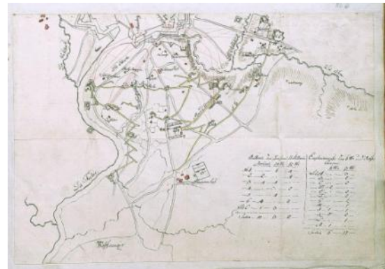
Abbildung 11: Belagerung von Kassel im siebenjährigen Kriege; Krokis der angegriffenen Fulda-Fronte mit Trancheen (Annäherungsgräben) und (Demontier)Batterien sowie deren Schußlinien von der 1. und 2. Parallele. Durch Spionage oder Aufklärung wurde offenbar das Tracé (Grundriß) der Festung bekannt, so daß sich die besten Positionen der Angriffsbatterien leicht im Terrain bestimmen ließen. (Zeitgenössisch, vermutlich während der Belagerung entstanden, Digitales Archiv Marburg)
