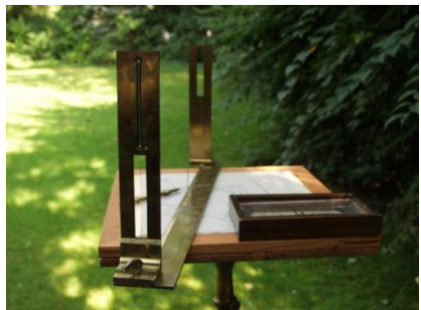
Abbildung 20: Rekonstruierte Meßtischaufnahme; auf der Platte zu sehen sind: Das vom Rahmen eingeklemmte Papier, sowie Diopterlineal, Nadel, Porte crayon und die Bussole als Zulegeinstrument (© Autor)
