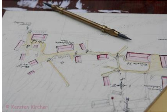
Abbildung 21: Rekonstruierte Meßtischaufnahme 1:1000 nach Hogrewe, im Vordergrund das Blatt mit der Nadel für den Standort, die jüngst aufgenommenen Teile im Vordergrund nur mit Blei gezeichnet, die früheren bereits illuminiert (© Autor)
