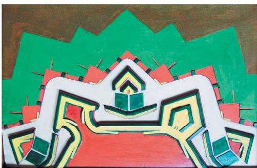
Abbildung 8: Vaubans erste Manier vom Anfang des 18. Jahrhunderts mit niedrigem Aufzug des Hauptwalls, Vollbastion mit Katze (rechts), zurückgezogenen Flanken (linke Bastion), Grabenscheren, Kaponniere zum Wallschild. Oberer Wallschild mit Reduit. Ausgebaute Waffenplätzen in den einspringenden Waffenplätzen. Siehe zum Beispiel Zitadelle Wesel (Modell nach Zastrow).
