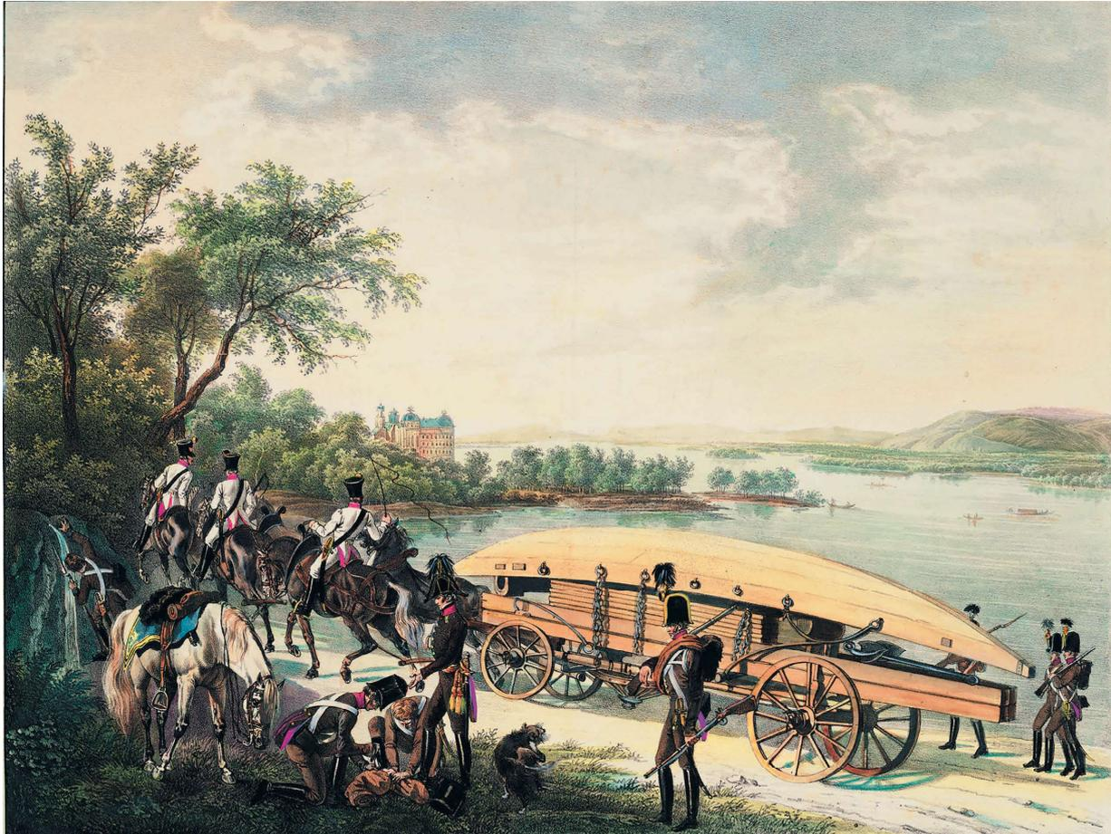
Abbildung 7: Abfahren eines k.k. Pontons auf einem Hacket mit den unterlegten Balken, Anker und Werkzeugen (nach Hauslab, Wien, 1820, Anne S. K. Brown Collection, Brown University Library).
