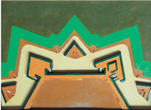
Abbildung 6: Neuitalienische Manier aus dem Anfang des 17. Jahrhunderts mit hohem Aufzug des Mauerwerks, Kanonenhöfen in den Flanken, Katze in der rechten Bastion, kleinen Wallschilden und Waffenplätzen. Siehe zum Beispiel Spandau, Küstrin und Dresdner Altstadt (Modell nach Zastrow).
