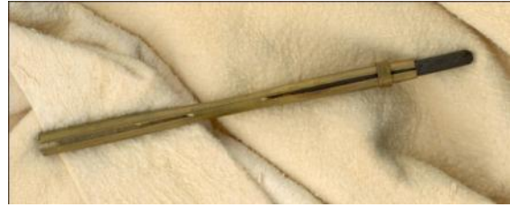
Abbildung 63: Porte-crayon mit eingespannter Kohle, wie solcher meist den mathematischen Bestecken beigegeben ist.
