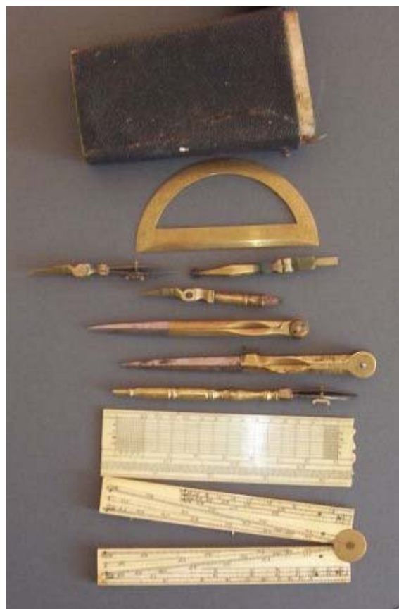
Abbildung 78: Mathematisches Taschenbesteck mit Zirkeln, Ziehfeder, Transversalmaßstab, Proportionalzirkel (England, Ende des 18. Jahrhunderts)
