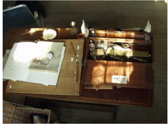
Abbildung 39: Geöffneter Skripturkasten mit den Utensilien eines Geometers, wie Transversalmaßstab, Parallellineal, Sonnenuhr, Börse, Schere, Reiselicht, Schreibfedern, Tinte (engl. Writing slope aus Mahagoni um 1810-1820, Inhalt teilweise rekonstruiert)
