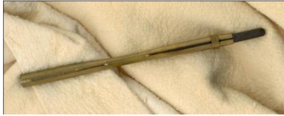
Abbildung 60: Port- crayon mit eingespannter Kohle, wie solcher meist den mathematischen Bestecken beigegeben ist.
