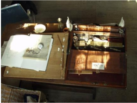
Abbildung 36: Geöffneter Skripturkasten mit den Utensilien eines Geometers, wie Transversalmaßstab, Parallellineal, Sonnenuhr, Börse, Schere, Reiselicht, Schreibfedern, Tinte (engl. Writing slope aus Mahagoni um 1810-1820, Inhalt teilweise rekonstruiert)
