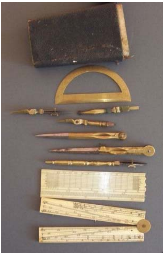
Abbildung 75: Mathematisches Taschenbesteck mit Zirkeln, Ziehfeder, Transversalmaßstab, Proportionalzirkel (England, Ende des 18. Jahrhunderts)
